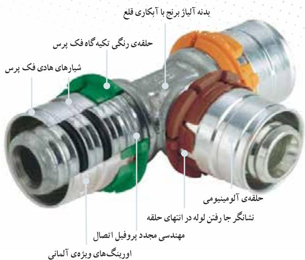
● اتصال سوپرپایپ  $2^+$  به صورت یکپارچه به لوله، پرس می‌شود و آببندی سیستم را به صورت کامل تر تأمین می‌کند.
